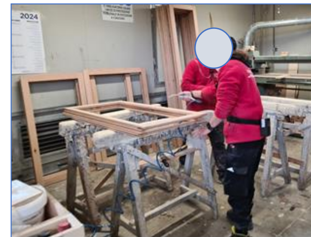
soffiaggio con aria compressa (pulizia del pezzo)
